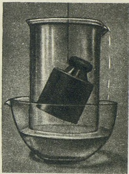
Вода, вытесненная из стакана опущенной в него гирей, собирается и взвешивается.
