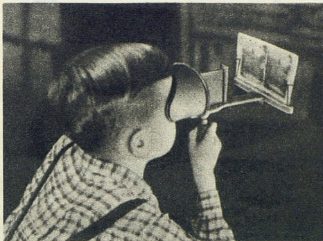
Стереоскоп для рассматривания стереофотографий.
