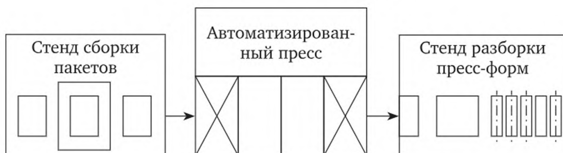
Рис. 2.52. Компонировка модуля прессования
