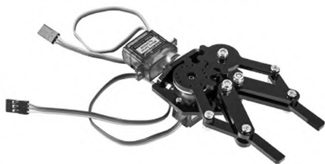
Рис. 3.35. Пример сменного рабочего инструмента в виде захватного устройства
