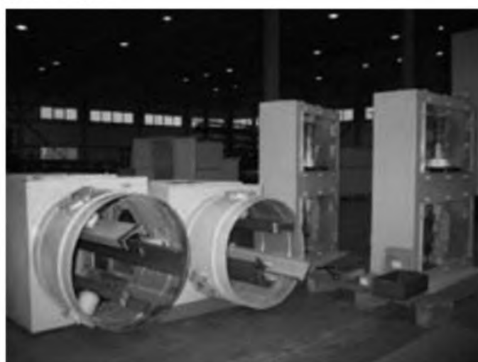
Рис. 5.8. Шинные токопроводы
