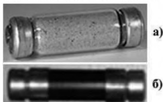
Рис. 4.20. Плавкие предохранители: а) НПН-2, б) ПР-2
