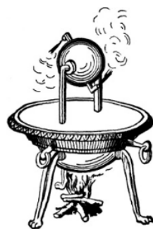
Рис. 1.16. Паровая турбина Герона (Википедия)
