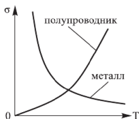
Рис. 29.31. С понижением температуры проводимость металлов возрастает и для чистых металлов стремится к бесконечности при приближении к абсолютному нулю. У полупроводников, напротив, с понижением температуры проводимость убывает, а вблизи абсолютного нуля полупроводник становится изолятором.
