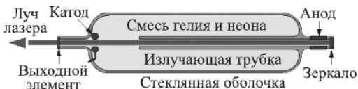
Рис. 29.25. Устройство гелий-неонового лазера (Википедия)
