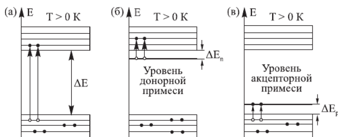
Рис. 29.32. Схемы энергетических уровней полупроводников:
