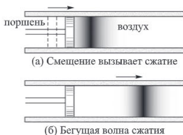
Рис. 16.25. Звуковая волна: а) поршень, резко сдвинувшийся в трубе в направлении стрелки, смещает соседние частицы воздуха, создает волну сжатия, т. е. звуковую волну, которая начинает распространяться в сторону от поршня; б) звуковая волна движется в воздухе с постоянной скоростью, вызывая временное повышение давления
