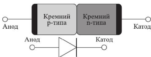
Рис. 29.35. Схема полупроводникового кремниевого диода. Ниже приведено его символическое изображение на электрических принципиальных схемах
