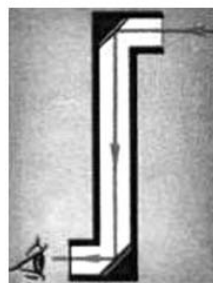
Рис. 17.9. Принципиальная схема перископа
