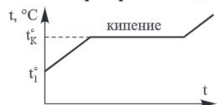
Рис. 12.13. Изменение температуры жидкости при нагревании
