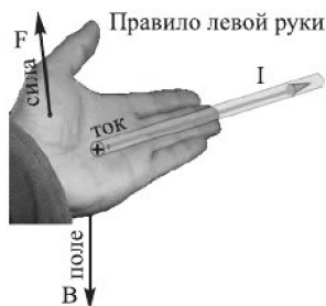
Рис. 22.12. Определение направления силы, действующей на проводник с током в магнитном поле
