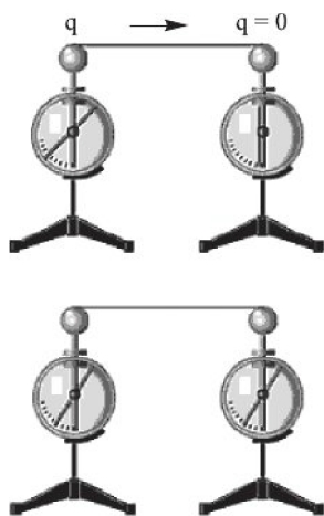
Рис. 20.4. Перетекание зарядов с заряженного электрометра на незаряженный приводит к появлению электрического тока
