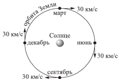
Рис. 32.8. Скорость Земли, измеряемая в одном направлении, изменяется на протяжении полугода примерно на 60 км/с. Если пространство абсолютно и в нем существует неподвижный светоносный эфир, то в экспериментах, проведенных на Земле, скорость света должна была бы изменяться на 60 км/с. Эксперимент Майкельсона–Морли такого изменения не обнаружил, что поставило под вопрос существование эфира (Encyclopaedia.big.ru)
