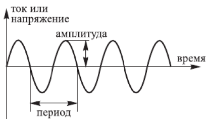
Рис. 25.3. График переменного тока и напряжения
