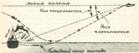
Схема торпедной атаки с самолета-торпедоносца.
