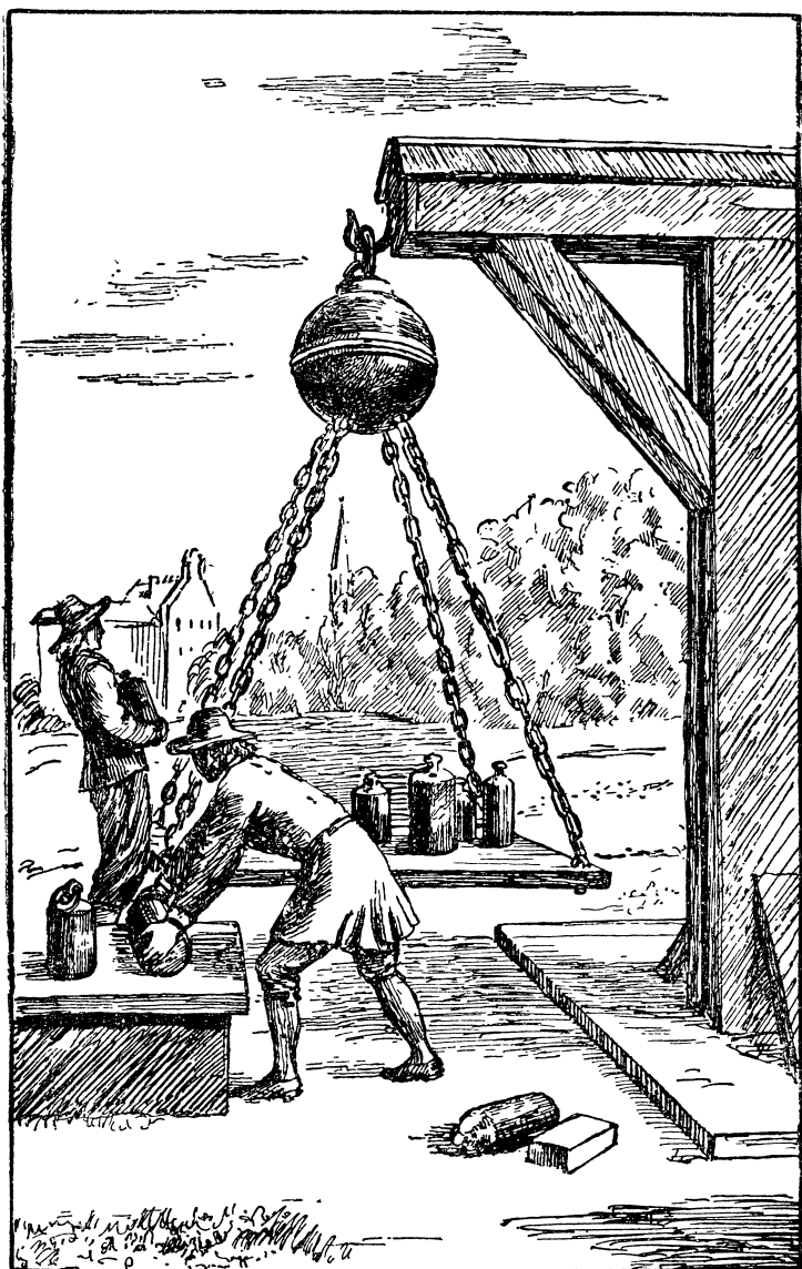
Опыт Герике. На стойке укреплены полушария, из которых выкачан воздух. Атмосферное давление удерживает тяжесть гирь, поставленных на платформу, подвешенную к нижнему полушарию.
