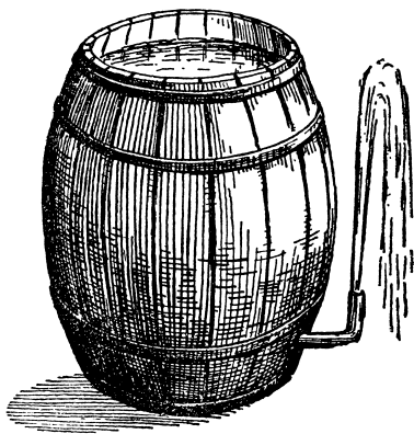
Опыт Торричелли с бочкой. Вода бьет из трубки струей, почти достигающей уровня воды в бочке.
