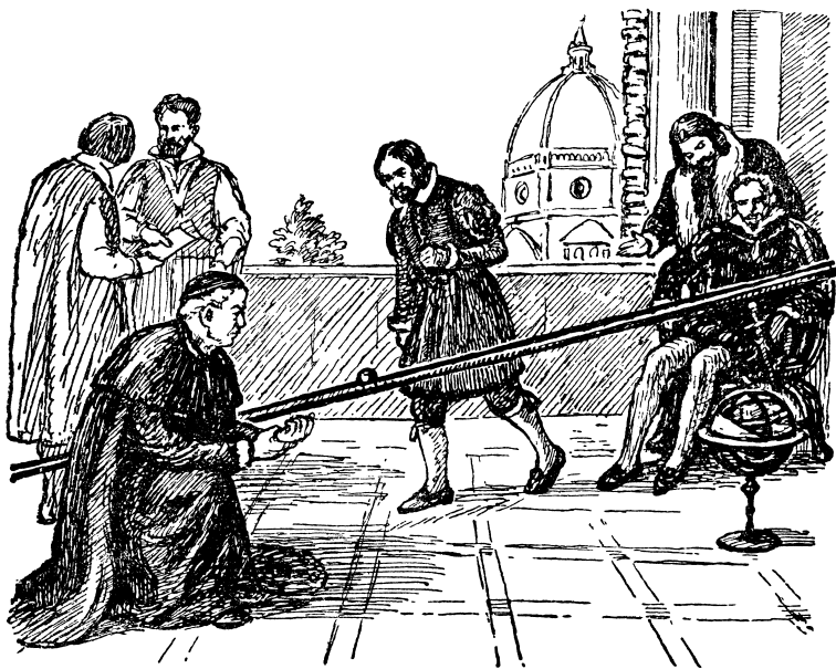
Опыт Галилея со скатыванием шариков по наклонной плоскости.
