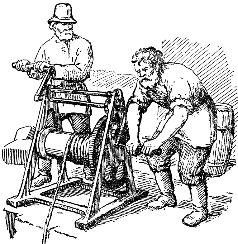
Ворот с зубчатым приводом — лебедка.
