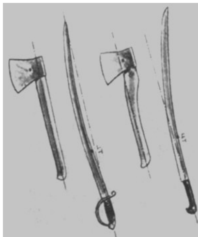
Рисунок 8.2. Слева – размещение центров тяжести без создания направляющего момента, справа – с созданием направляющего момента
