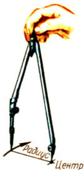
Рис. 15. Проведение окружностей циркулем
