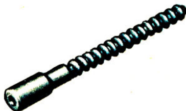
Рис. 266. Винт слесарных тисков
