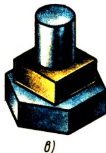
Рис. 127. Построение третьей проекции по двум данным
