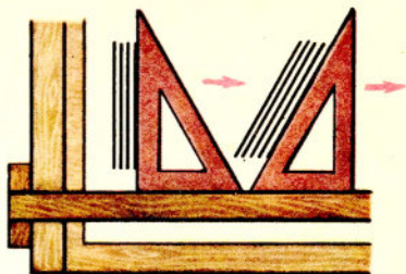
Рис. 14. Проведение вертикальных и наклонных линий по рейшине и угольнику
