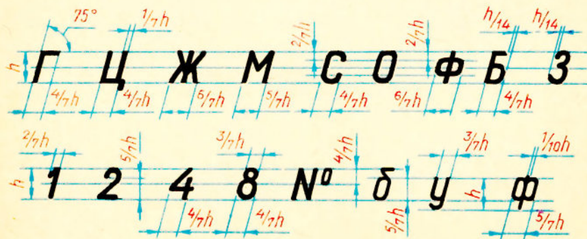
Рис. 25. Начертание букв и цифр чертежного шрифта
