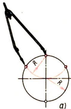
Рис. 136. Деление окружности на восемь равных частей
