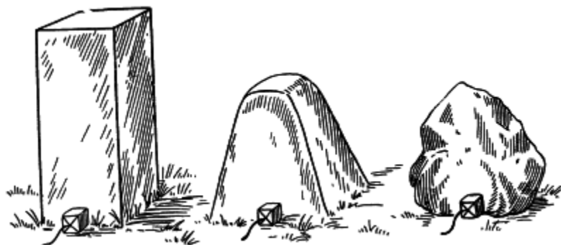
Рис. 42. Расположение зарядов для подрывания железобетонных и каменных надолб
