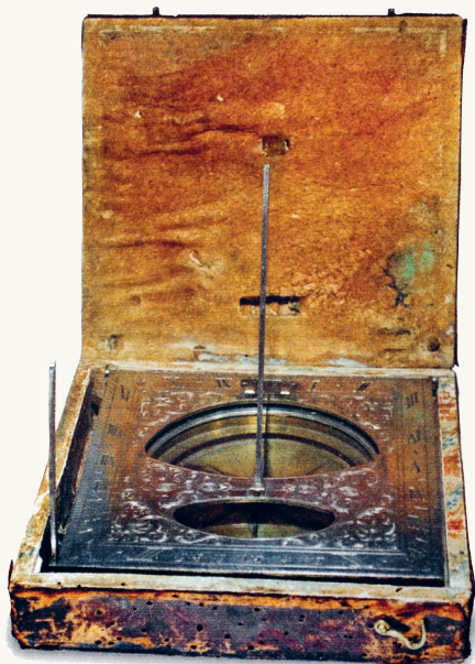
▼ Равноденственные солнечные часы, использовавшиеся в мореплавании в конце XVII — начале XVIII в.
