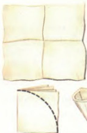
22. Изготовление фильтра.
