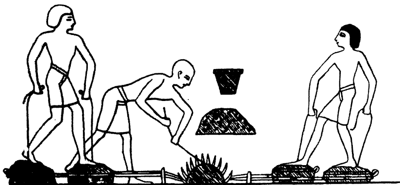
Получение металлов из руды и древесного угля в яме. Воздух вдувается кузнечными мехами.
