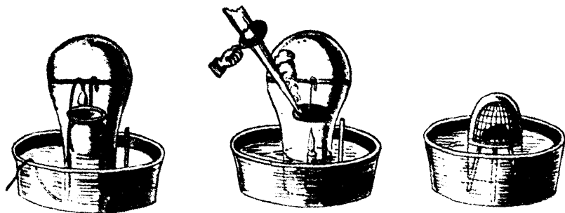
Приборы для демонстрации изменений в составе воздуха (из работы Дж. Мэйоу). Слева направо — при погружении железа в азотную кислоту; при сжигании камфоры с помощью нагревательной линзы; при дыхании животного (все опыты проводятся в закрытых объемах воздуха).
