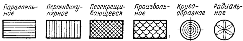
Рис. 33. Направление неровностей при обработке и их условные обозначения на чертежах.
