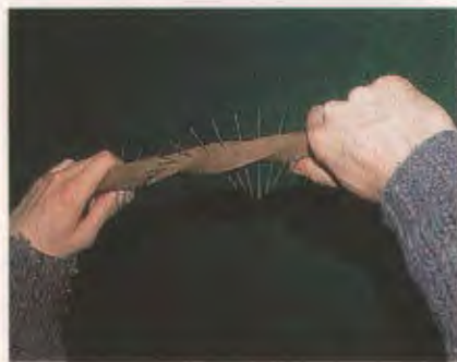
Деформация кручения (слева) и деформация сдвига.
