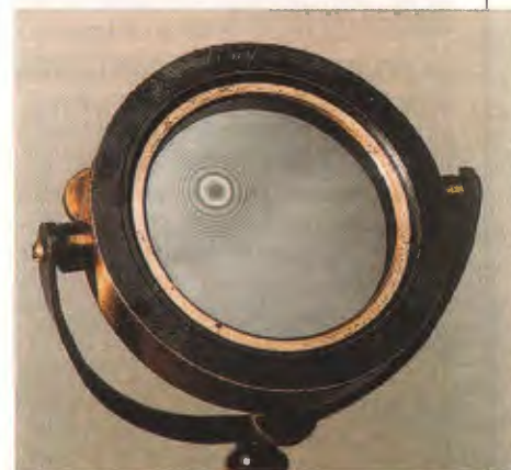
Кольца Ньютона. Результат интерференции лучей, отразившихся от поверхности линзы и пластины, — один из эффектов волновой оптики.
