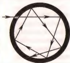
Полый шар с малым отверстием — модель абсолютно чёрного тела.
