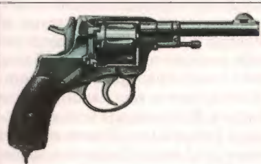
Револьвер системы «Наган» образца 1895 г.
