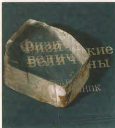
Преломление света в кристалле полевого шпата.
