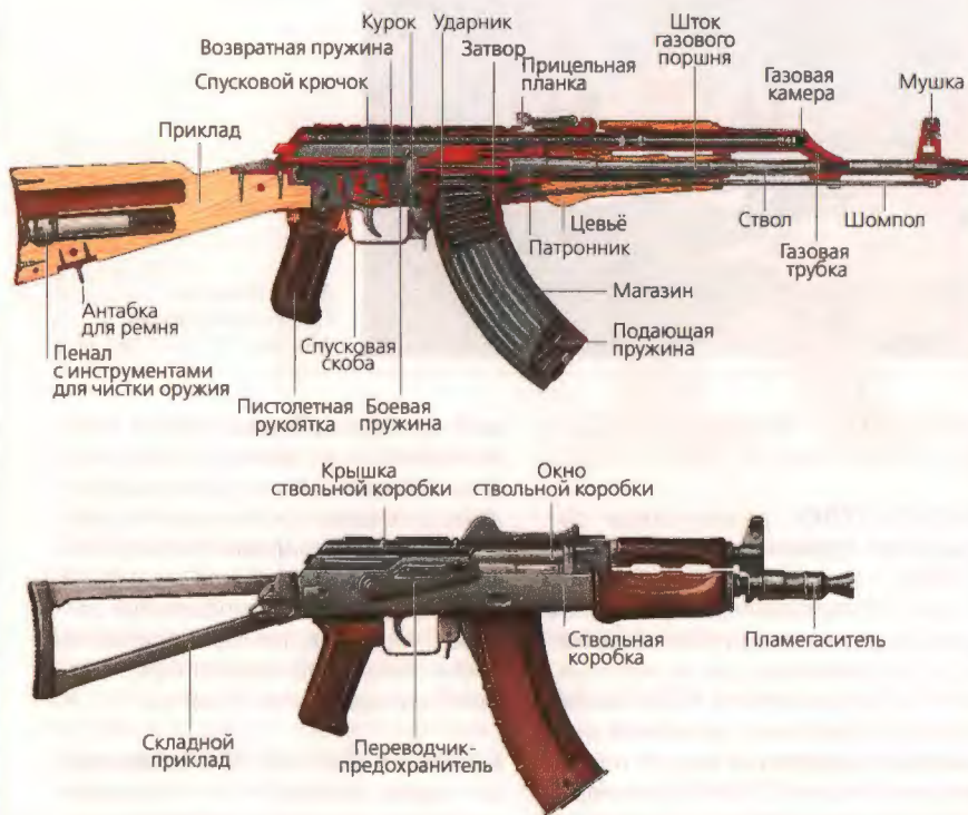
Устройство автомата Калашникова. В разрезе — АКМ; общий вид — АКС-74У.
