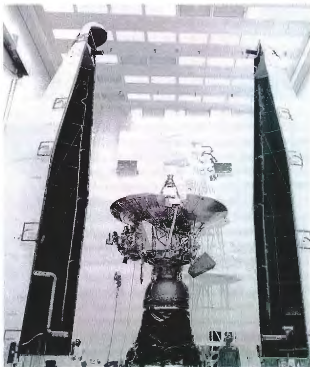
Установка АМС «Пионер-11» под головной обтекатель РН «Атлас-Кентавр».
