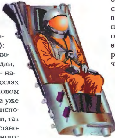
Катапультируемое кресло космонавта космического корабля «Восток».
