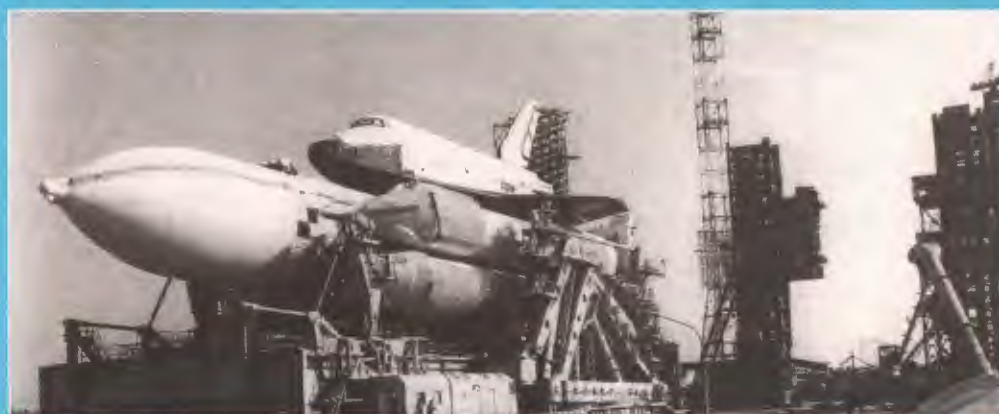
Вывоз системы «Энергия-Буран» на стартовую позицию
