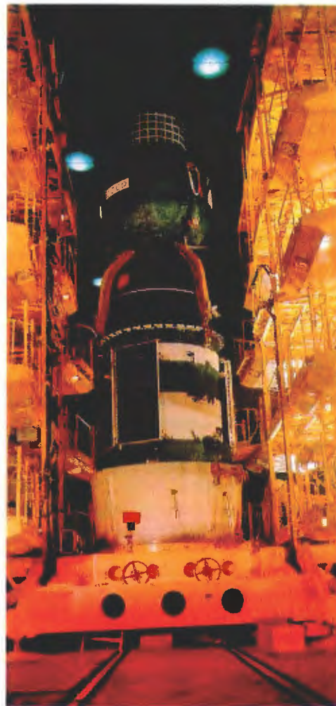
КК «Союз», укрытый теплоизоляционными материалами.
