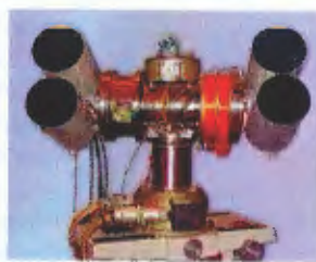
Межспутниковая лазерная система передачи информации.
