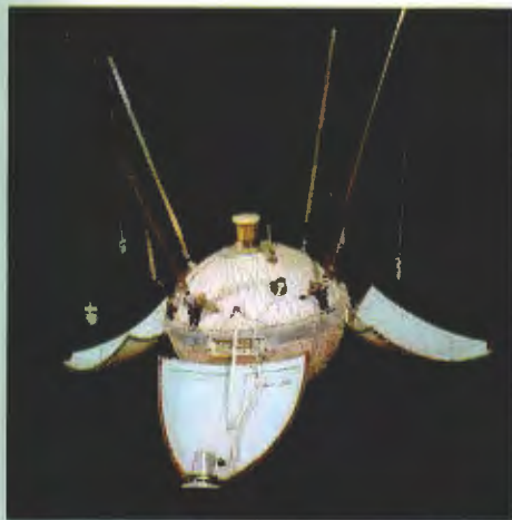
◀ Станция «Луна-9» (сверху видна панорамная камера). Музей НПО имени С. А. Лавочкина.
