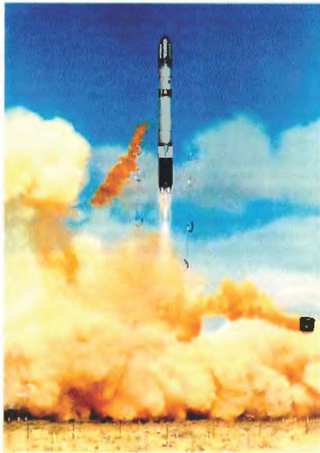
Старт РН «Днепр». Внизу справа виден уводимый в сторону от стартующей ракеты газогенератор. С его помощью был произведён миномётный выброс ракеты из шахты.
