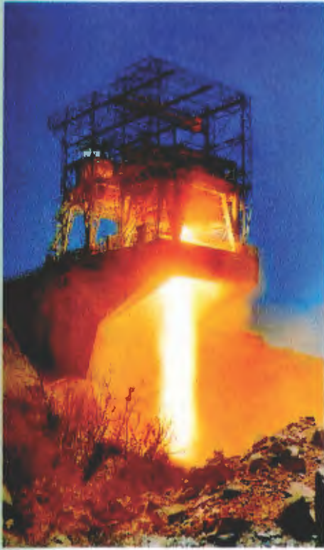
Испытания двигателя F-1 для первой ступени РН «Сатурн-V».
