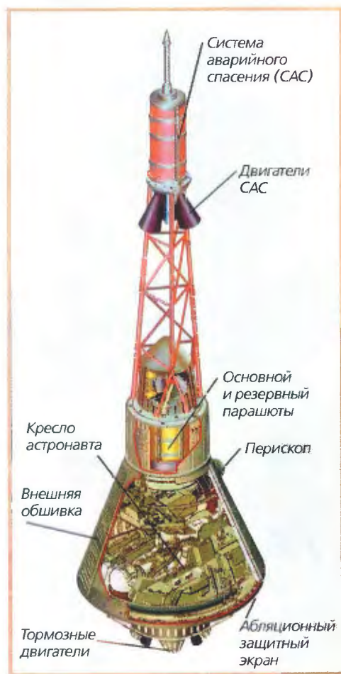
Схема космического корабля «Меркурий».
