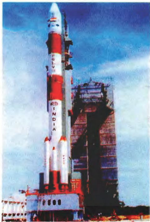
Индийская ракета-носитель PSLV, предназначенная для запуска спутников на полярную орбиту.
