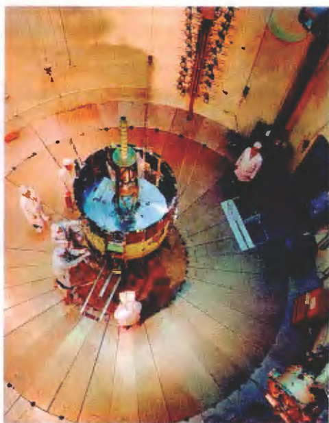
Монтаж космического аппарата ISEE-3.
