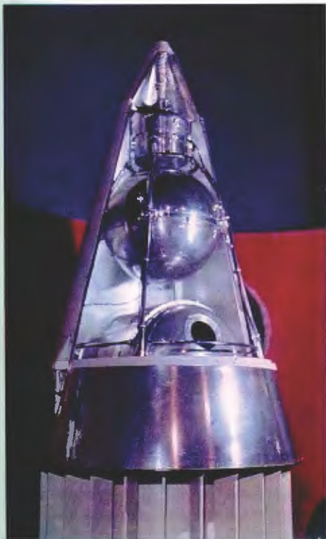
Головная часть второго советского спутника. Видна часть кабины Лайки.
