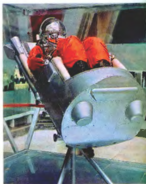
Катапультируемое кресло космического корабля «Восток».
