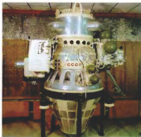
◀ Станция «Луна-9» (сверху видна панорамная камера). Музей НПО имени С. А. Лавочкина.
