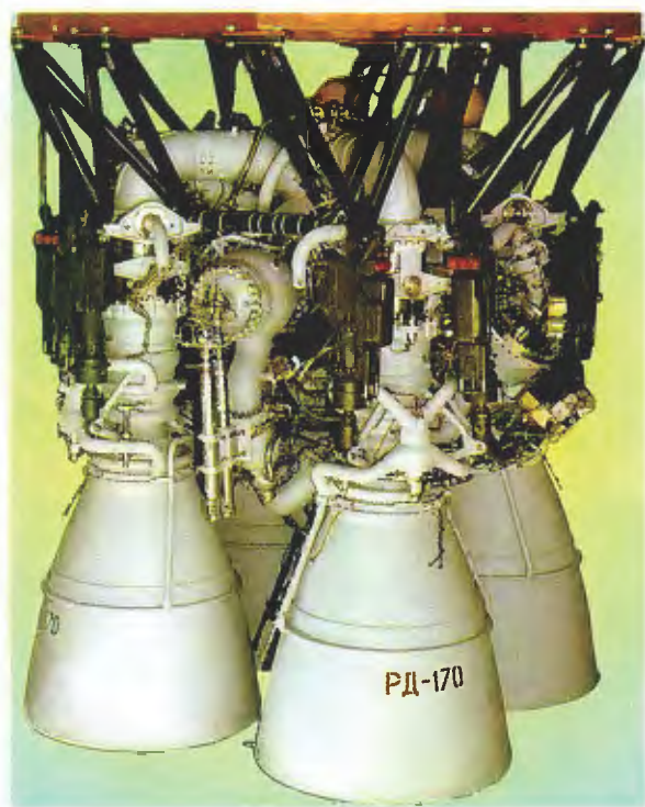
Жидкостно-реактивный двигатель РД-170.
