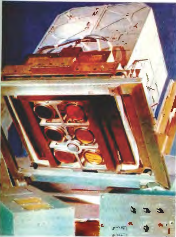
Многозональный космический фотоаппарат МКФ-6.
