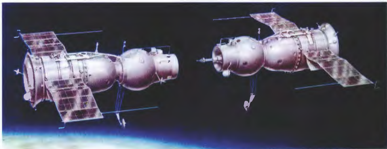
Так стыковались «Союз-4» (справа — с активным стыковочным узлом) и «Союз-5» (с пассивным стыковочным узлом).
