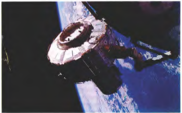
Манипулятор переносит шлюзовую камеру «Квест» в зону стыковки с модулем «Юнити»
