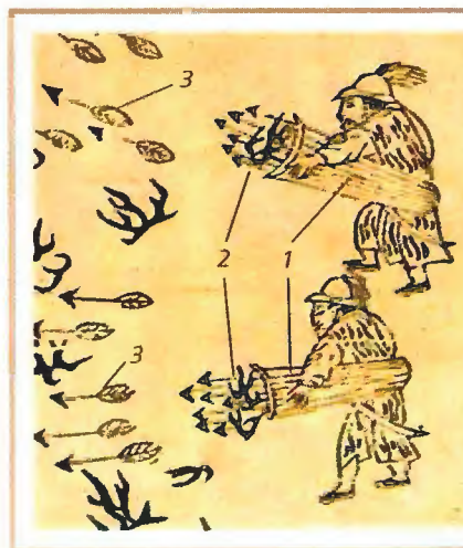
Китайская переносная 17–20-зарядная РСЗО (не позднее первой четверти XVII в.): 1 – транспортно- пусковой контейнер; 2 – стрелы-ракеты, размещённые в контейнере; 3 – стрелы-ракеты в полёте.
