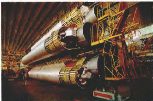
Сборка РН «Протон» в цехе ГКНПЦ имени М. В. Хруничева.
