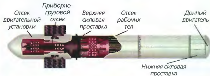
Так выглядит орбитальный завод «Полюс» — гражданский вариант «Скифа».
