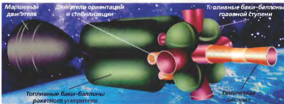
Так выглядит орбитальный завод «Полюс» — гражданский вариант «Скифа».
