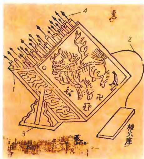
Китайская передвижная 36-зарядная РСЗО (не позднее 70-х гг. XVIII в.): 1 — пакет направляющих; 2 — фитиль; 3 — лафет; 4 — стрелы-ракеты
