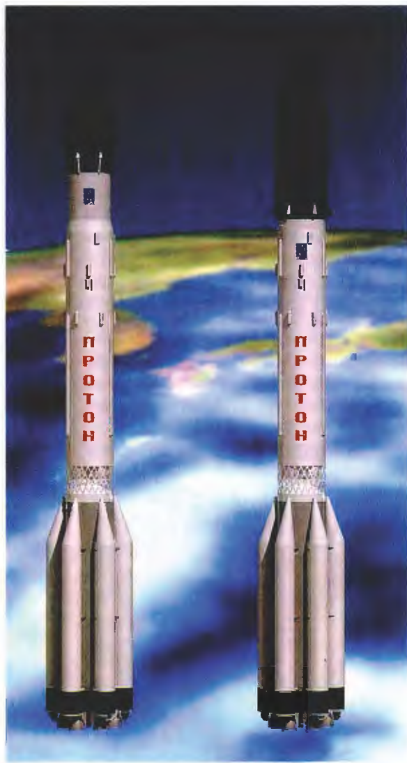
РН «Протон» с разгонным блоком «ДМ» (слева) и разгонным блоком «Бриз М» (справа).
