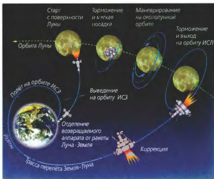
Схема полёта АМС «Луна-16»
