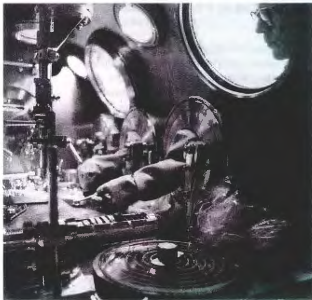
Исследуется грунт из Моря Кризисов, привезённый на Землю советской АМС «Луна-24». На переднем плане — свёрнутый спиралью грунтонос.
