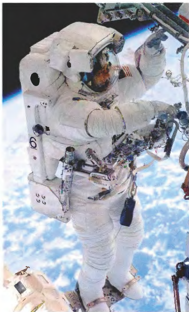
Инструменты для работы в открытом космосе закрепляются на поясе, чтобы не «уплыли».
