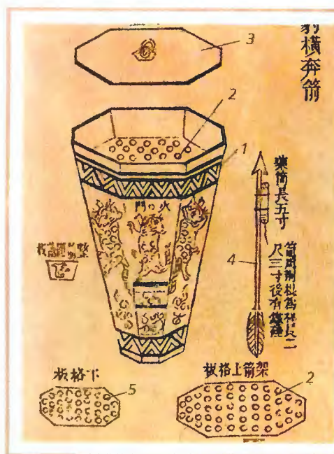
Китайская передвижная 36-зарядная РСЗО (не позднее 70-х гг. XVIII в.): 1 — пакет направляющих; 2 — фитиль; 3 — лафет; 4 — стрелы-ракеты
