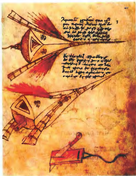
«Ракетная торпеда». Рисунок из рукописи Дж. да Фонтаны. 1420 г. Дощечка с воткнутым в неё ножом (внизу) привязывалась позади «торпеды» и служила рулём.
