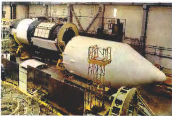
Установка головного обтекателя на КА «Алмаз-1В».
