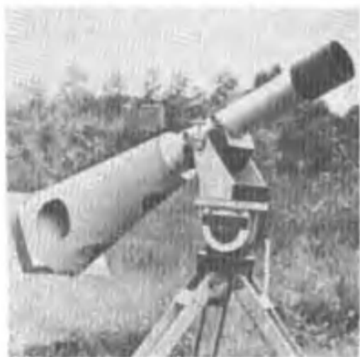
Рис. 4. Рефрактор с затемненным экраном для зарисовки Солнца (изготовлен членами кружка школы № 5 Углича).
