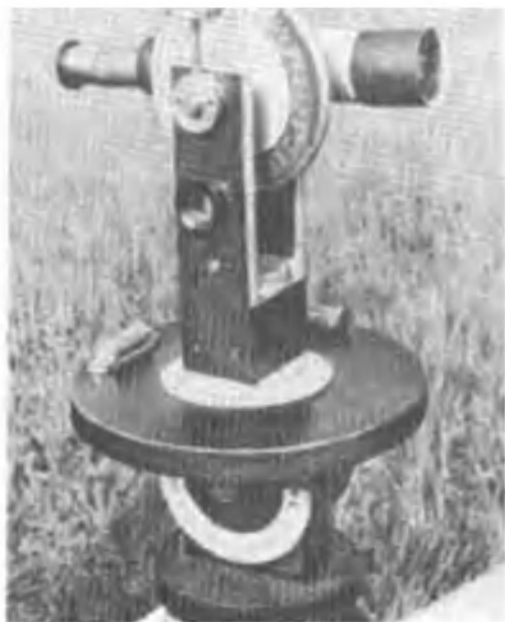
Рис. 5. Самодельный универсальный угломерный инструмент.
