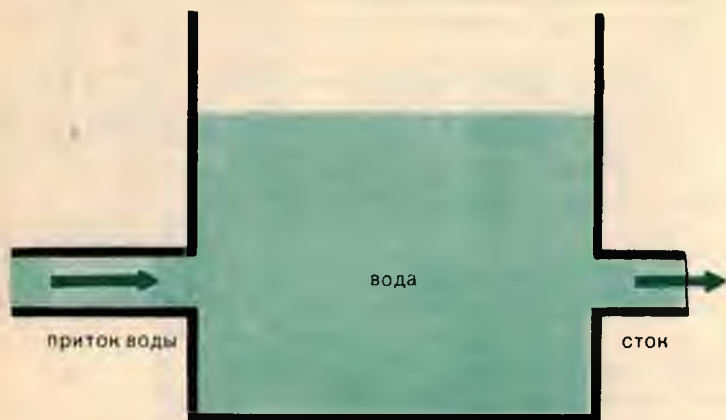
24—10. Проточный сосуд, находящийся в состоянии динамического равновесия.
