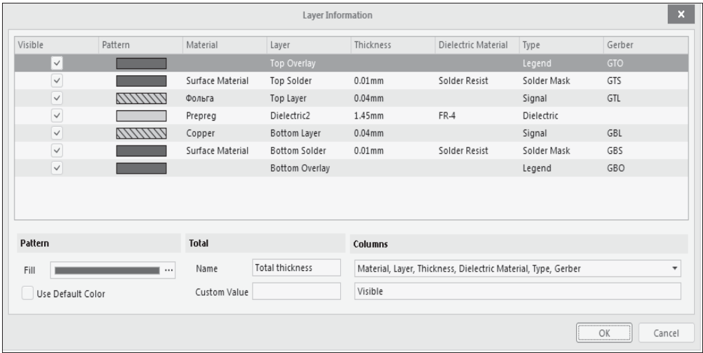
Рис. 12.25. Сведения о структуре слоев платы
