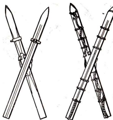
Рис. 126. Приспособление против отдачи лыж назад
