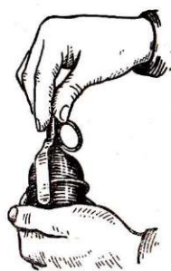
Рис. 172. Ввинчивание запала в трубку корпуса гранаты
