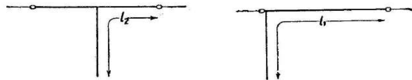
Рис. 514 и 515. Т-образная и Г-образная антенны.
