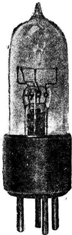
Рис. 509. Термовакуумный элемент с термоккестом.
