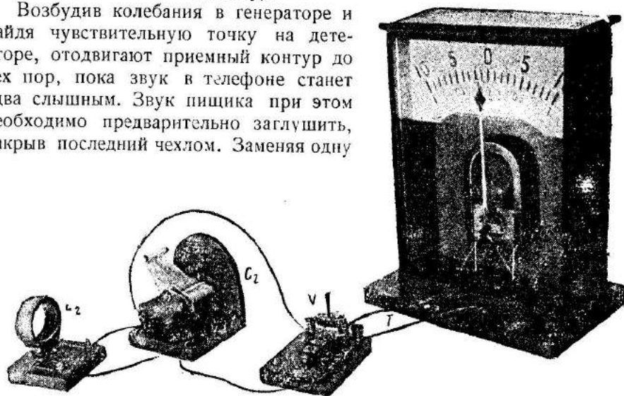
Рис. 492. Контур для демонстрации резонанса (с детектором и гальванометром).
