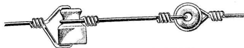
Рис. 523. Изоляция антенны (из роликов).
