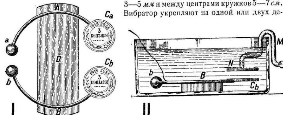
Рис. 550. Детали самодельного прибора Лехера.
