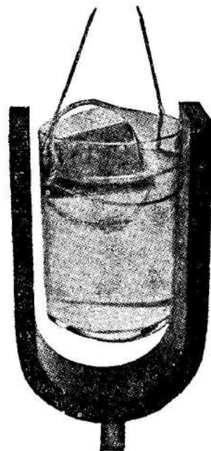
Рис. 212. Опыт с плавающим витком.
