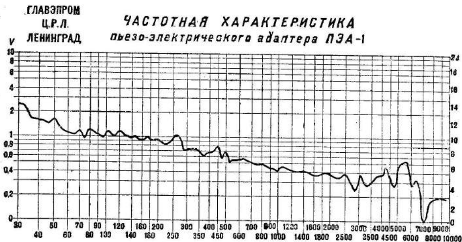
Рис. 352. Характеристика пьезоэлектрического адаптера.
