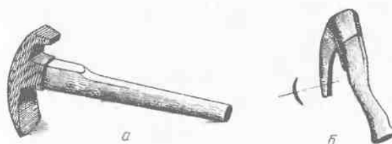
Рис. 40. Тесло: а — для вырубания крупной щепы; б — для чистовой обработки вогнутых поверхностей
