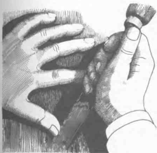
Рис. 74. Срезание древесины прямой стамеской приемом «на себя»
