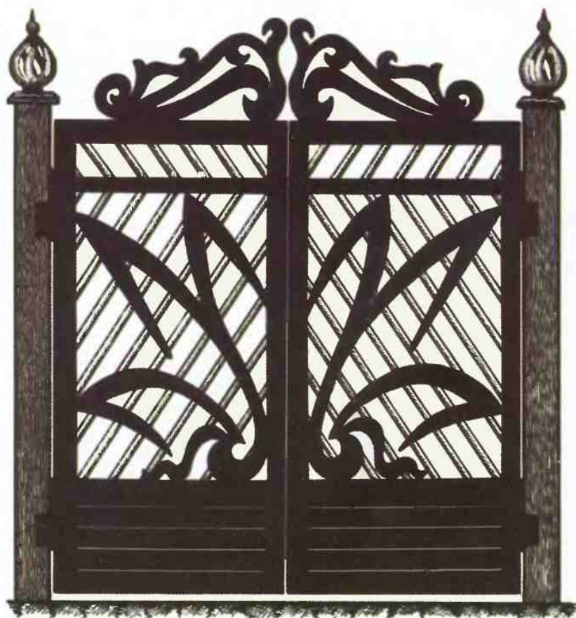
Рис. 8. Вариант ворот с использованием наклонных стержней в качестве диагональных распорок
