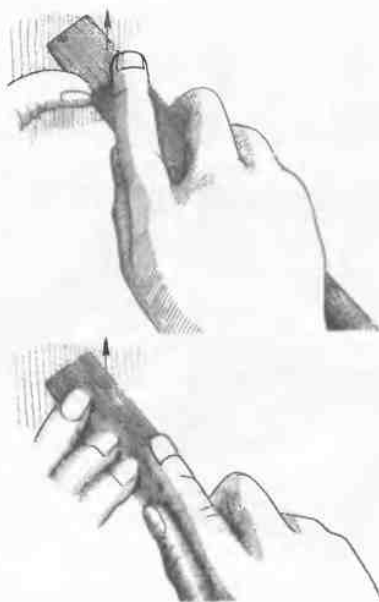
Рис. 72. Приемы зачистки поверхности поделки плоской стамеской
