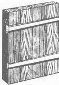
Рис. 173. Сплачивание брусков в щит с помощью клиновидных шпонок
