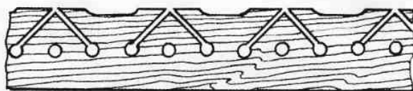
Рис. 231. Ленточные орнаменты накладной и прорезной резьбы, составленные: a — из трех досок, состыкованных по линиям кромок; б — из двух досок (выступы одной доски заходят в углубления другой); в — из двух досок, отделенных друг от друга интервалом для затемнения вырезанной ломаной полосы; г — из вертикальных дощечек, пропиленных по контуру до сверления отверстий (верхний ряд), и двух горизонтальных досок (нижний ряд). Внизу даны увеличенные детали
