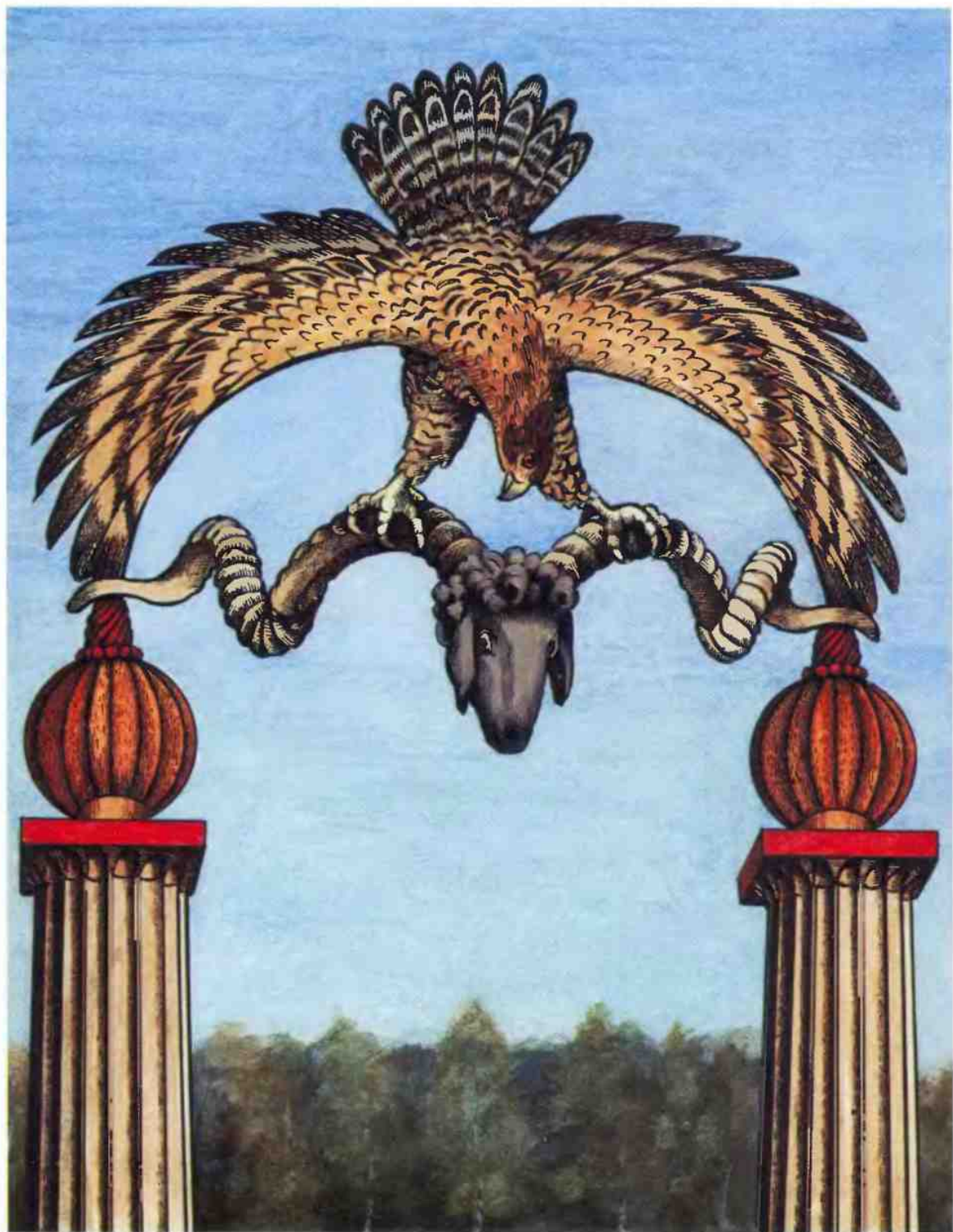
Рис. 9. Арка к калитке с расстоянием между осями колонн 135—150 см. Орел и голова барана набраны из деревянных деталей на сварном каркасе из труб, которые пропущены через шары по осям колонн.
