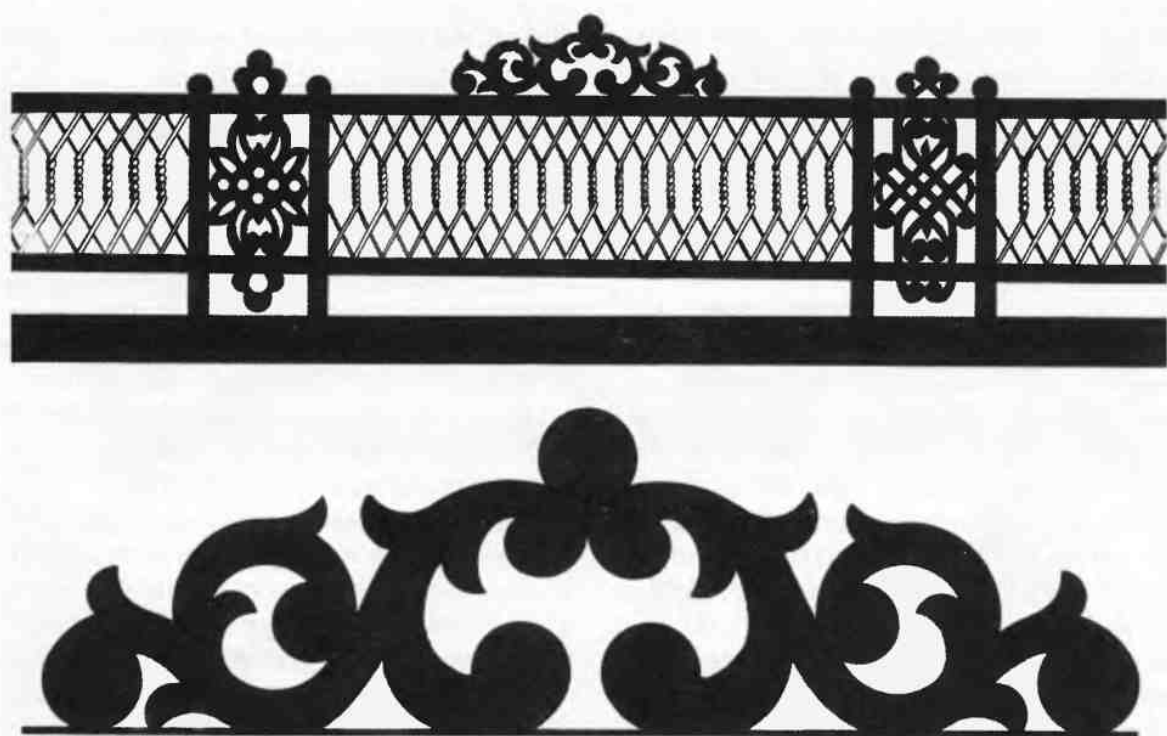
Рис. 277. Гребень крыши с резными орнаментами, выполненный из дерева и толстой алюминиевой проволоки. Даны варианты промежуточных орнаментов и отдельно изображение верхнего орнамента
