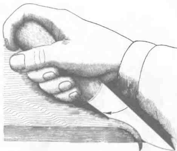
Рис. 102. Срезание толстого слоя древесины вдоль или поперек волокон захватом ножа одной или двумя руками с поворотом лезвия в кисти правой руки (локоть прижат, кончик ножа «смотрит» на локоть)
