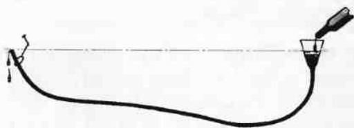
Рис. 593. Определение горизонтальной линии с помощью трубки, наполненной водой
