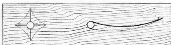
Рис. 242. Выпиливание мелких и узких отверстий с кривым контуром. Предварительные пропилы ножовкой с узким кончиком (слева) и лучковой пилой (справа) показаны толстой линией, последующие расширения отверстий ножом до нужного контура — штрихпунктирной линией
