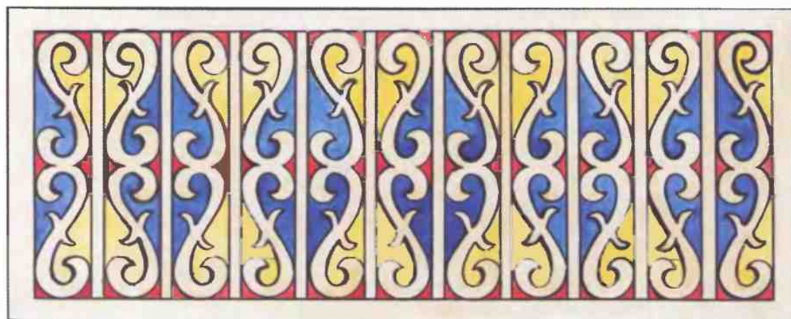
Рис. 40. Два варианта орнамента витража, выполненного вставкой полос стекол в пазы вертикальных стоек и наложением криволинейных элементов на стекле: а — из стекол двух цветов (для симметрии цветные полосы лучше сделать спаренными); б — с раскраской простых стекол цветными лаками
