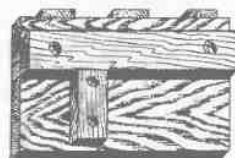
Рис. 36. Низкая посадка резчика. Использование рабочей доски вместо верстака. Рабочая доска, заменяющая резчику верстак
