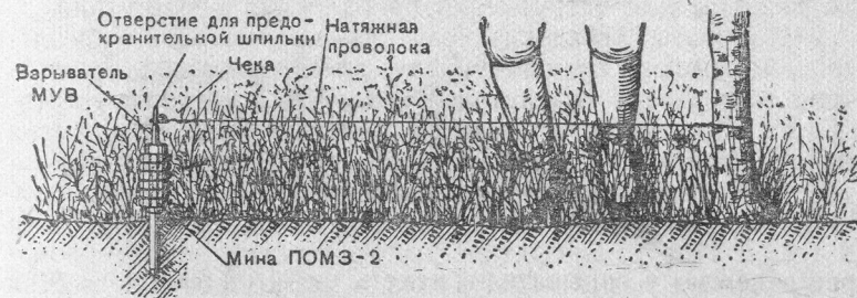
Рис. 159. Противопехотная осколочная мина ПОМ 3-2 (установка на местности)
