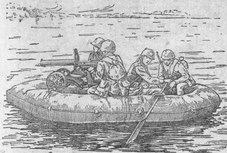
Рис. 188. Расположение на лодке четырёх бойцов и станкового пулемёта
