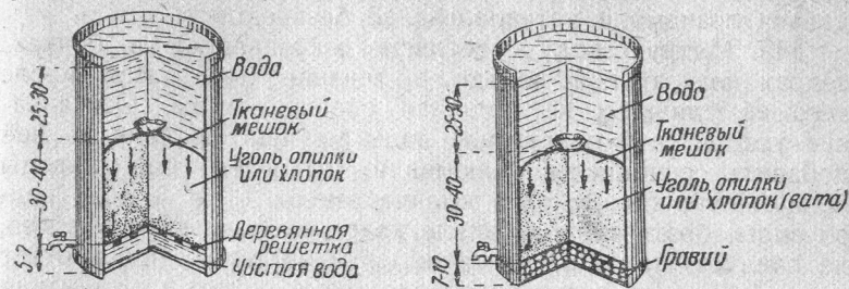
Рис. 223. Фильтр с фильтрующим материалом в тканевом мешке
