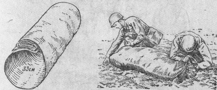
Рис. 181. Свёртывание плащ-палатки, используемой в качестве оболочки поплавок
