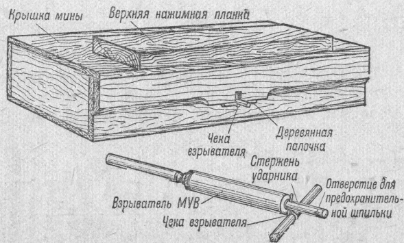
Рис. 157. Противотанковая мина ЯМ-5
