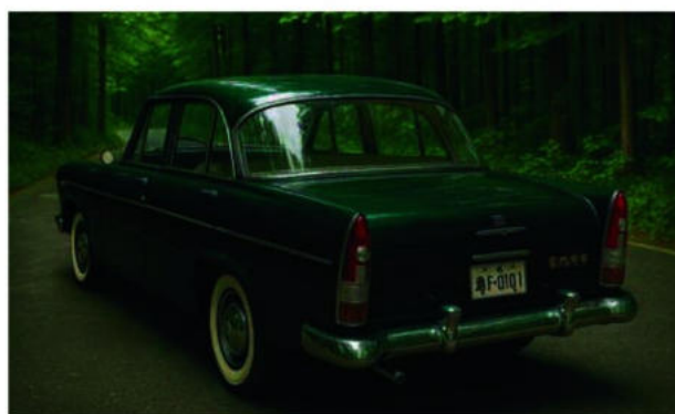
■ Мягкие обводы кузова, задние крылья с ярко выраженными «плавниками» и крупные задние фары в форме традиционных китайских фонарей делают CA71 узнаваемым гибридом французского дизайна, отечественных особенностей и немецкой инженерной базы.
