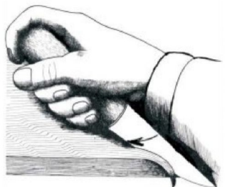
Рис. 38. Срезание толстого слоя древесины вдоль волокон одной рукой (локти прижаты)
