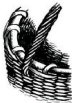
Рис. 29. Крепление ручки корзинки к обручу
