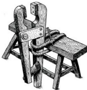
Рис. 5. Самодельные деревянные тиски с накладными губками и с зажимом при помощи клина
