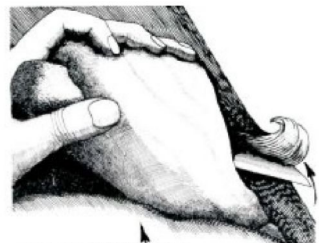
Рис. 39. Срезание древесины вдоль волокон двумя руками приёмом «от себя» с нажимом корпуса
