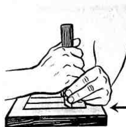
Рис. 79. Положение косячка при резбе выемок вдоль волокон
